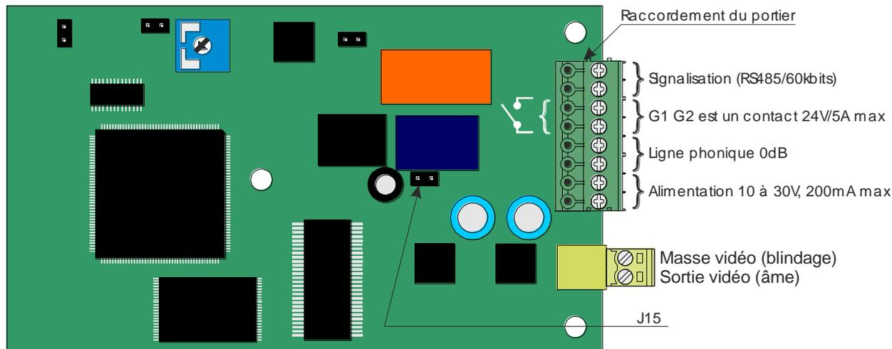
L'alimentation est assurée soit par la ligne bus soit par le central. On peut aussi alimenter l'appareil par une alimentation locale (Bloc secteur 24VDC/5VA relié aux bornes Masse/+12V, Option CASTEL: réf:540.6000).
